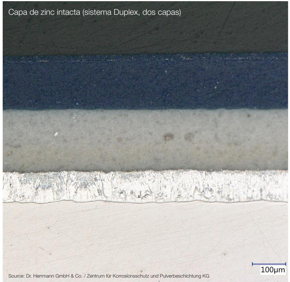
Capa de zinc intacta (sistema Duplex, dos capas)
