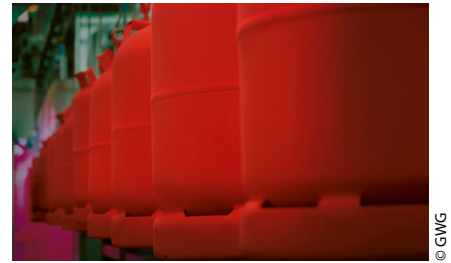
Beschichtete Gasflaschen vor dem Einbrennen.
