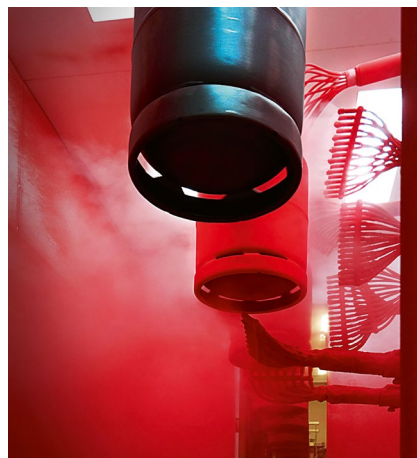
Leichtbaufflaschen während des Beschichtungsprozesses.
