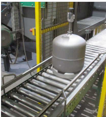
Gestrahlte Leichtbaufflasche vor dem Beschichtungsprozess.
